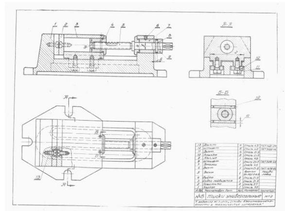
2. Размерный анализ. Рассчитать размерную цепь заданным методом и способом по чертежу узла.
